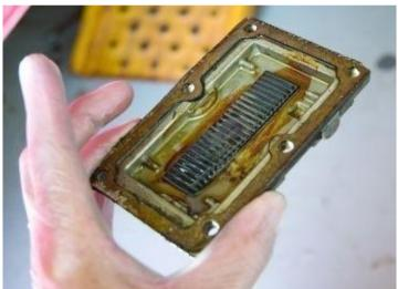
Démonter le couvercle inférieur (4 vis ) et son joint.
