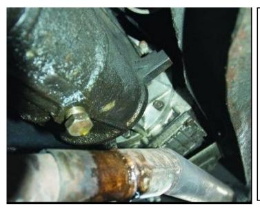
Vidanger I 'huile de la boite de vitesse et d'overdrive par I 'orifice situé sous la BV. Il en restera encore un peu dans I 'OD qui coulera lors du démontage du couvercle inférieur.
